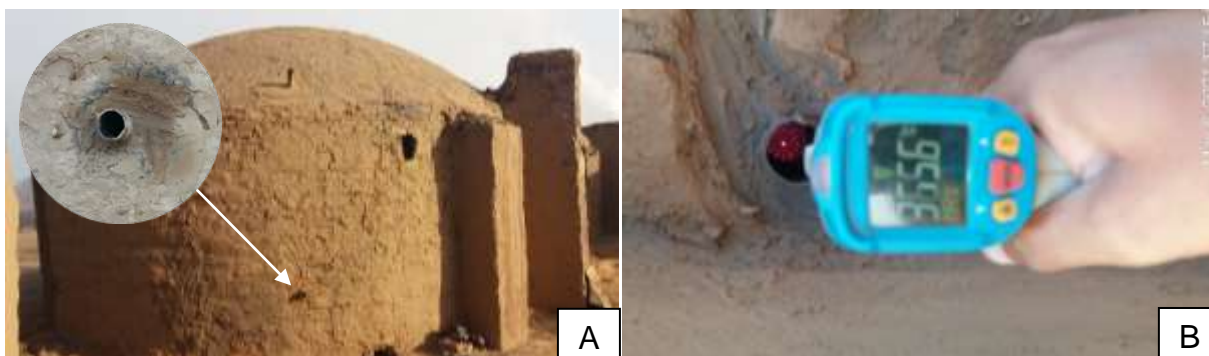
Figura 2 – Procedimento utilizado para monitoramento da temperatura durante o processo de carbonização. (A) Forno de alvenaria com detalhe da entrada dos cilindros metálicos; (B) obtenção da temperatura o sensor infravermelho Minpa do modelo MT-350 a . Fonte: Costa (2021).
