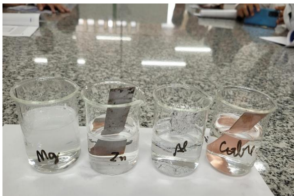
Figura 3: Experimento dos metais em solução de ácido clorídrico
