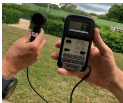
Figura 4 - Medidor de Ultravioleta modelo MRU-201 Fonte: Imagem dos autores (2024)
