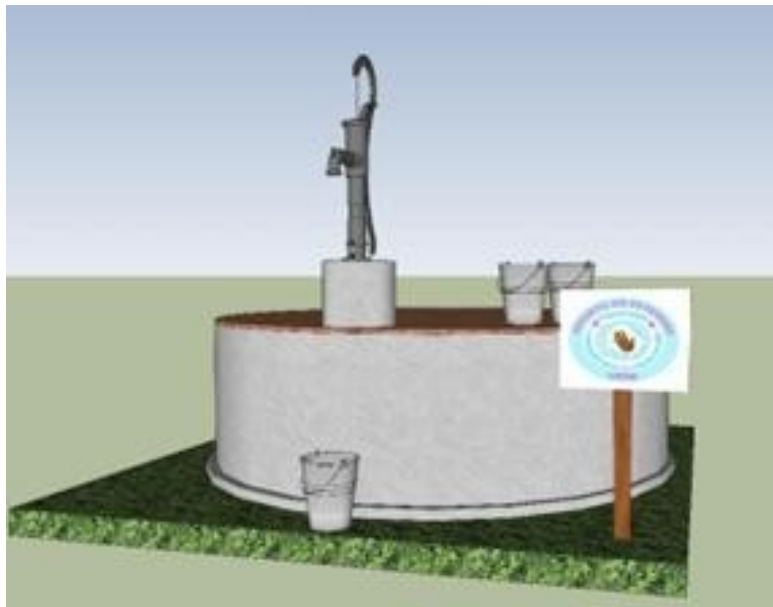
Figura 2. Bomba de água manual para poço caipira de nascentes de água. Fonte: Modificado da FUNASA, 2014.
