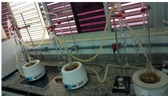
Figura 1 - Hidrodestilação em aparelho do tipo Clevenger
