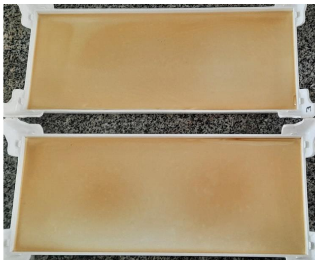
FIGURA 1 – Amostra do filme de PVOH com adição do extrato da Xanthosoma sagittifolium .
