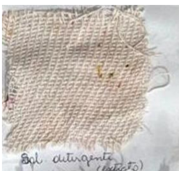
FIGURA 2A. Mancha de extrato de tomate após lavagem com solução de detergente
