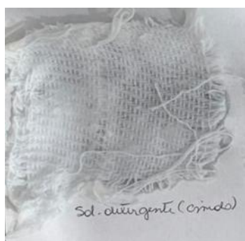
FIGURA 2B. Mancha de amido após lavagem com solução de detergente
