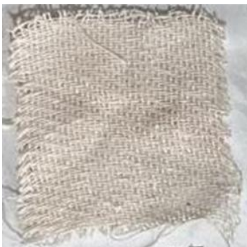
FIGURA 4A. Mancha de extrato de tomate após lavagem com solução de detergente + EBE
