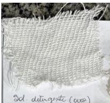
FIGURA 2C. Mancha de ovo após lavagem com solução de detergente
