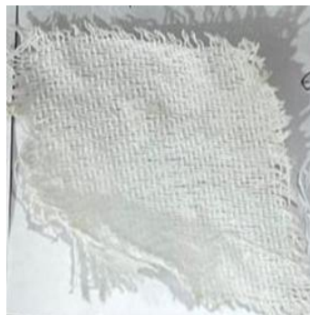
FIGURA 4B. Mancha de amido após lavagem com solução de detergente + EBE
