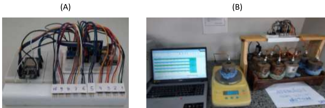
FIGURA 1: (A) Protótipo de coleta de dados dos sensores. (B) Estrutura com protótipo de coleta instalado. FONTE: Autor.
